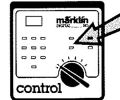
Als ferngesteuerte Zusatzfunktion (function) kann beim Digital-Betrieb die fahrtrichtungs-abhängige Stirnbeleuchtung ein- und ausgeschaltet werden.
